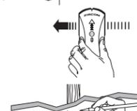
Markieren Sie diese zweite Kante. Die Kantenmitte befindet sich genau zwischen den zwei Markierungen.
