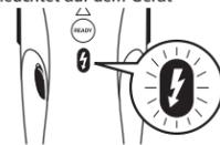
**⚠ WARNHINWEIS** Ortungsgeräte, die ein spannungsgeladenes Umfeld scannen, können möglicherweise nicht spannungsführende Leitungen orten, wenn die Wand feucht ist, oder wenn die Leitungen tiefer als 51 mm von der abgesannten Oberfläche liegen, bzw. in einem Rohr, hinter einer Scherwand oder metallischer Wandverkleidung.
