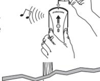
Halten Sie weiterhin die Ein/Austaste gedrückt und scannen Sie in die gleiche Richtung weiter, über die markierte Stelle hinaus, bis das Zeichen EDGE nicht mehr rot aufleuchtet. Bewegen Sie das Gerät nun in die entgegengesetzte Richtung, um die zweite Balkenkante zu finden.
