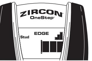
Fahren Sie mit dem Scannen fort. Sobald das Zentrum des Holzbalkens geortet wird, werden drei Balken rechts auf der Signal-Stärke Anzeige angezeigt und ein akustisches Signal ertönt. Gleichzeitig erscheinen die vier Balken in der Mitte des Displays, sowie das Wort CENTER (Zentrum), und das SpotLite® Pointing System leuchtet auf.
