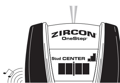
In het geval van diepere stijlen (of dikkere wanden) zullen twee balkjes op de Signaalsterkte-indicator worden weergegeven en alleen de SpotLite en de vier middelste balkjes zullen branden. Als u de stijl nog niet kunt vinden, doe dan DEEP SCAN modus.
