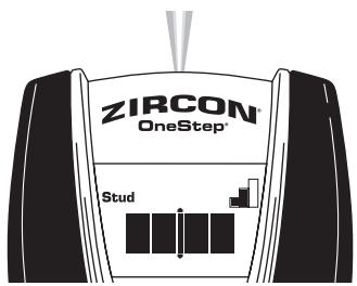
Dans le cas d'objets plus profonds (ou de surfaces plus épaisse) deux barres seront indiquées par l'Indicateur de Force de Signal et seul le SpotLite® Pointing System et quatre barres centrales s'allumeront. Si vous ne pouvez toujours pas situer un objet, essayez en DEEPS CAN®.
