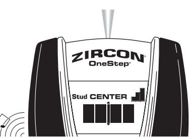
Bei dickeren Holzbalken (oder dickeren Wänden) werden zwei Balken rechts auf der Signal-Stärke Anzeige angezeigt, und nur das SpotLite® Pointing System und die vier Balken in der Mitte des Displays leuchten auf. Falls Sie danach weiterhin keinen Balken orten können, stellen Sie bitte auf DEEPSCAN® (tiefes Scannen) um.
