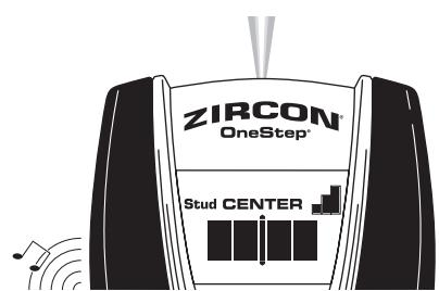
Continuez à faire glisser l'outil. Quand il détectera le centre de l'objet avec trois barres sur l'Indicateur de Force de Signal, il émettra un signal sonore, et les quatre barres, l'afficheur CENTER et le pinceau lumineux du SpotLite® Pointing System s'allumeront.
