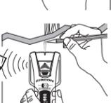
Halten Sie weiterhin die Ein/Aus-Taste gedrückt und scannen Sie in die gleiche Richtung weiter, über die markierte Stelle hinaus, bis das Zeichen EDGE nicht mehr rot aufleuchtet. Bewegen Sie das Gerät nun in die entgegengesetzte Richtung, um die zweite Balkenkante zu finden.
